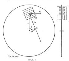
Prinzipieller Aufbau des Kurzschlussankermotors mit variabler Drehzahl
