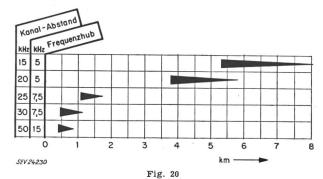
Minimalentfernung des Nebenkanalsenders bei Änderung von Kanalabstand und Frequenzhub (nach H. H. Davids)
