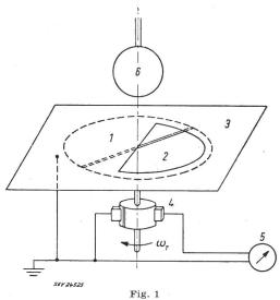
Schematische Darstellung eines Spannungsmessers mit der Elektrodenanordnung Kugel—Ebene
