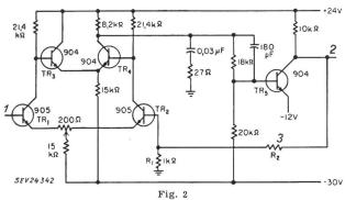
Stabiler Gleichstromverstärker mit npn-Transistoren 60 db Spannungsverstärkung 1 Eingang; 2 Ausgang; 3 Gegenkopplung
