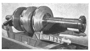
Fig. 1 Rotor einer Speicherpumpe für das Kraftwerk Limberg der Tauernkraftwerke A.-G.
