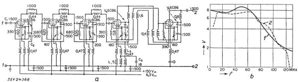
Fig. 3 Fünfstufiger Allpass-Verstärker
