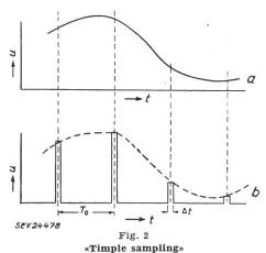
a kontinuierliches Signal; b impulsmoduliertes Signal t Zeit; u Signal
