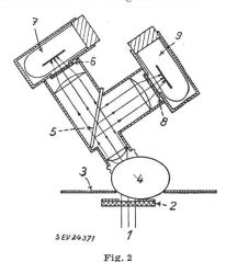
Optische Anordnung des photoelektrischen Prüfgerätes
