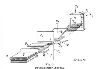
$u_1$  Eingangssignal;  $u_2$  quantisiertes Ausgangssignal; 1 Flachstrahl; 2 getasteter Strahl; S strahlerzeugendes System; k Kathode;  $D_1$ ,  $D_2$  Ablenkplatten;  $C_2$  Blende für die Quantisierung und Signaltrennung;  $K_1$  quantisierter Kollektor (Auffangelektrode); K2 Restkollektor
