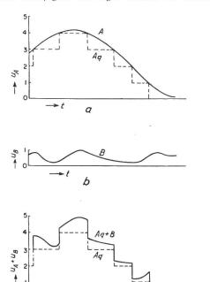
Fig. 1 Quantisierung und Addition der Signale A und B
