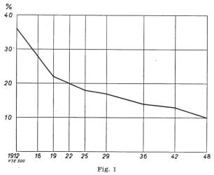
Anteil des Lichtanschlusswertes in Prozenten des Gesamtanschlusswertes aller Verbrauchsapparate
