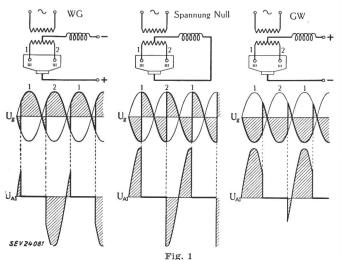
Prinzipielle Wirkungsweise eines Mutators im Gleich- und Wechselrichterbetrieb
