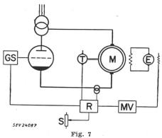
Prinzipschema der modernen Steuerung eines Umkehrwalzwerkes in Eingefäßschaltung mit Feldumkehr
