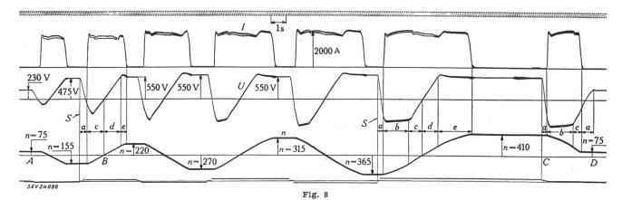
Folge von Reversiervorgängen eines mutatorgesteuerten Umkehrmotors im Leerlauf
