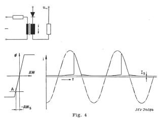
Prinzip der magnetischen Gittersteuerung Schaltbild, Magnetisierungskurve des Kerns der Drosselspule und Stromverlauf
