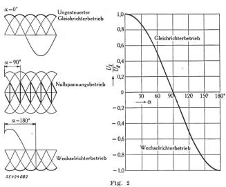
Steuercharakteristik eines gittergesteuerten Mutators  $\alpha$  Steuerwinkel;  $U_I$  gesteuerte Gleichspannung;  $U_{II}$  ungesteuerte Gleichspannung
