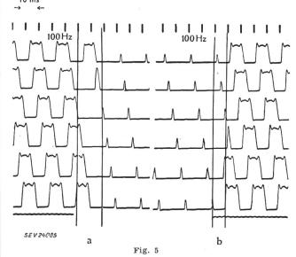
Dynamisches Verhalten eines Rapid-Gittersteuersatzes Verschiebung der Gitterimpulse bei plötzlicher Änderung des Steuersignals
