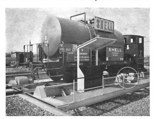
Fig. 1 Feinstopmotor (im Kreis) 10/1,5 PS, 1450/170 U./min, zum raschen und genauen Verstellen einer Schiebebühne
