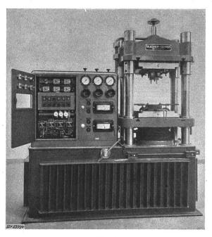
Fig. 1 150-t-Kunstharzpresse mit elektrischer Steuereinrichtung
