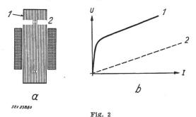
$\begin{array}{c} \textbf{Isthmus-Drosselspule} \\ a \ \text{Aufbau} \\ 1 \ \text{Isthmuskern}; \quad \textbf{2} \ \text{Luftspalt-Drosselspule} \end{array}$
