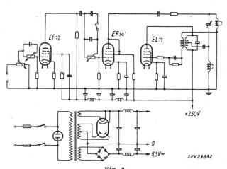
Prinzipschaltschema des Aufsprechteils am Tiefton-Magnetgerät
