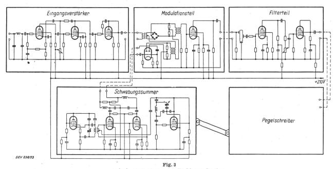
Prinzipschaltschema des Suchtonanalysators
