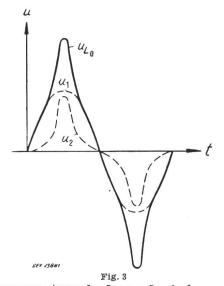
Zusammensetzung der Lampen-Leerlaufspannung u Spannung; t Zeit;  $u_{lo}$  Lampen-Leerlaufspannung (Spannung an den Lampenelektroden bei nichtzündender Lampe);  $u_{l}$  Netzspannung;  $u_{l}$  Impulsspannung (Zündungsimpuls)
