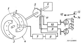
Fig. 3 Zweikanalschaltung mit hoher Empfindlichkeit für die Rücklichter
