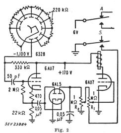
Schaltung mit Photozellen-Vervielfacher für mobile Anwendung mit einem Verstärkungsfaktor  $v=60\,\mathrm{db}$  A Abblendung; S Scheinwerfer
