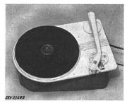
triebsvorrichtung sind an einer Aluminiumplatte befestigt, welche durch eine Isolierpreßstoffplatte überdeckt ist. Kristall-Pic-up für Normal- und Langspielplatten. Flachschnur mit Stecker für den Netzanschluss und abgeschirmtes Spezialkabel mit Steckern für den Grammoanschluss. Der Plattenspieler ist für Einbau in ein Holzgehäuse vorgesehen.
