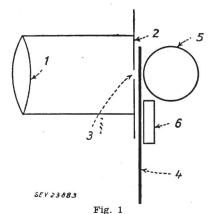
Einfachste optische Anordnung für Abblendung mittels Abtastscheibe
