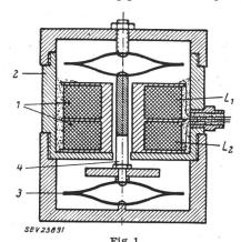
Schnittbild eines trägerfrequenten Schwingungsaufnehmers mit veränderbarer gegenseitiger Induktion zweier Spulen 1 zwei voneinander getrennte Spulen L<sub>1</sub> und L<sub>2</sub>; 2 zylindrisches Gehäuse; 3 Blattfedern; 4 Tauchkern
