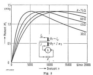
Prinzipschaltung und Bremskurven eines Gegenstrom-Generators bei verschiedenen Bremswiderständen
