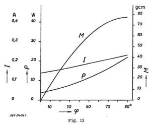
Drehmoment M, Strom- I und Leistungsaufnahme P eines Synchro-Empfängers in Abhängigkeit vom Nacheilwinkel  $\varphi$  (Winkelfehler der elektrischen Welle)
