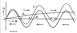
Fig. 8 Auftreten falscher Nullstellen bei direkter Überlagerung von Grob- und Feinwert
