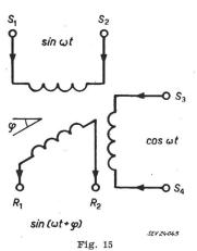
Verwendung des Resolvers als Präzisions-Phasenschieber  $S_1...S_4$  Anschlüsse der Statorwicklungen;  $R_1$ ,  $R_2$  Anschlüsse der Rotorwicklung;  $\varphi$  Winkel zwischen der Rotorwicklung und einer Statorwicklung
