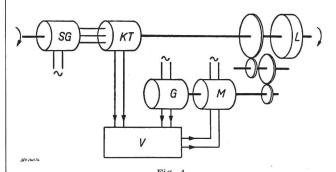
Positions-Servosteuerung mit Synchros und Dämpfung mittels Tachometer-Gegenkopplung
