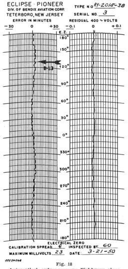
Automatisch aufgenommene Eichkurve eines Präzisions-Synchros
