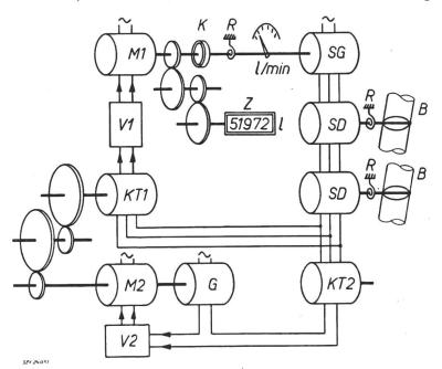
des Geberrotors über die Wirbelstromkupplung erforderliche Drehzahl erreicht. Nimmt jetzt z. B. der Verstärkungsgrad des Verstärkers  $V\,1$  ab, so sinkt auch die Drehzahl des Motors  $M\,1$  und der Rotor des Gebers bleibt etwas hinter seinem Sollwert zurück. Am Kontrolltransformator  $KT\,2$  entsteht da-
