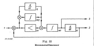
1 Durchflussgeschwindigkeit, Messwert; 2 Durchflussgeschwindigkeit, Anzeigewert; 3 Gesamtverbrauch, Anzeigewert (Zählwerk); VI Verstärker; MI, M2 Integrierendes Element (Motor); K differenzierendes Element (Wirbelstrom-Kupplung; G Tachometer-Generator
