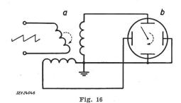
Verwendung des Resolvers zur Übertragung der Antennenrichtung auf die Anzeigeröhre eines Rundsicht-Radargerätes (schematisch)
