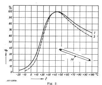
Lichtstrom  $\Phi$  (Mittelwerte) als Funktion der Rohrwandtemperatur t für Leuchtstofflampen
