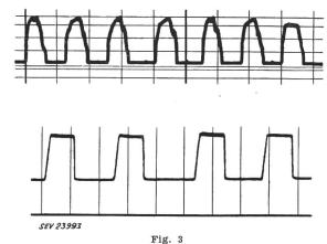
Geschwindigkeits-Zeitdiagramm einer Fördermaschine
