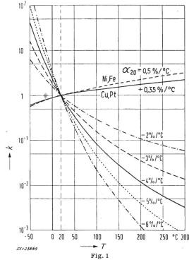
Das Widerstandsverhältnis ( $k \equiv R\tau/R_{20}$ ) von Eigenhalbleitern als Funktion der Temperatur (T) bei verschiedenen Werten des Temperaturkoeffizienten ( $\alpha$ :0) bei 20 °C
