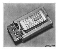
Das Vorschaltgerät hat die Prüfung in Anlehnung an die «Kleintransformatoren-Vorschriften» (Publ. Nr. 149) bestanden. Verwendung: in trockenen und zeitweilig feuchten Räumen.
