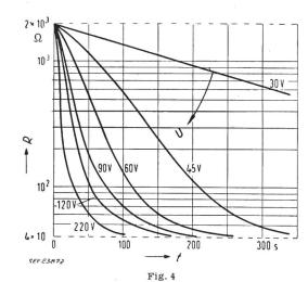
Widerstandsabnahme eines Heissleiters grosser Masse als Funktion der Zeit bei verschiedenen Spannungen
