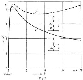
Spannung U an einer Regelheissleiterperle als Funktion des Stromes I
