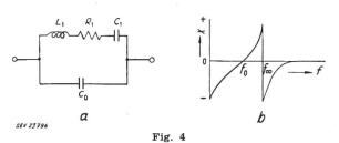
Ersatzschema und Reaktanzverlauf des piezoelektrischen Wandlers
