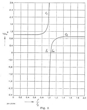
Verlauf der normalisierten Dielektrizitätskonstanten  $\epsilon/\epsilon_a$  als Funktion der normalisierten Frequenz  $f/f_0$  Dielektrizitätskonstante bezogen auf den asymptotischen Wert bei ganz tiefen Frequenzen  $\epsilon_a$ ; Frequenz bezogen auf die Resonanzfrequenz  $f_0$
