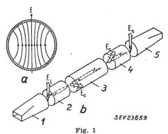
Wirkungsweise des Wellenleiter-Phasenschiebers TE<sub>11</sub>-Welle im runden Wellenleiter Zusammenwirken der Wellenleiterabschnitte 1...5
