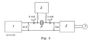
Messvorrichtung zur Messung der piezoelektrischen Eigenschaften von Kristallen und elektrostriktiver Keramik
