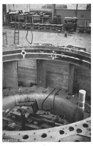
Fig. 1 Leitapparat einer Kaplan-Turbine für das Kraftwerk Rheinau
