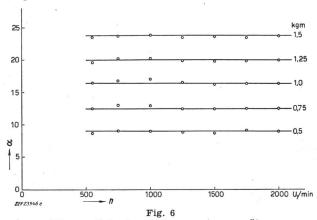
Messresultate des Drehmomentmessgerätes n Drehzahl; & Ausschlag des Instrumentes
