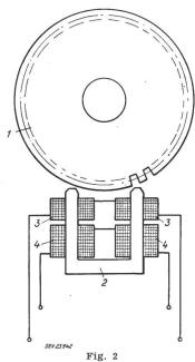
Grundsätzlicher Aufbau der Messgeneratoren
