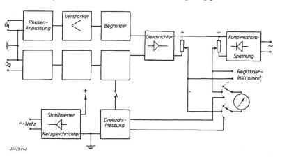
Einrichtung konnte jede beliebige Drehzahl und jedes gewünschte Drehmoment eingestellt werden (Fig. 5). Die Messeinrichtung gestattete, wie bereits erwähnt, die Eichung des Anzeigeinstrumentes in kgm. Fig. 6 zeigt die mit der beschriebenen Anordnung erzielten Messergebnisse. Die Ausschläge des Messinstrumentes sind über die Drehzahl und das Drehmoment als Parameter eingetragen. Der Drehzahlbereich erstreckte sich von 500...2000 U./min.
