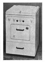
Kochherd gemäss Abbildung, mit drei Kochstellen, Backofen, Deckel und Schublade. Kochplatten von 145, 180 und 220 mm Durchmesser mit Rand aus rostfreiem Stahlblech fest montiert. Platte von 180 mm Durchmesser mit «EGO-Wart» ausgerüstet. Herd mit fester Schale. Backofenheizkörper für Ober- und Unterhitze ausserhalb des Backraumes angeordnet. Gemeinsame Regulierung derselben durch einen Temperaturregler. Anschlussklemmen für verschiedene Schaltungen eingerichtet. Handgriffe aus Isoliermaterial.
