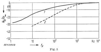
Bewertung von Störspannungen in Funktion der Pulsfrequenz Ladezeitkonstante des HF-Gleichrichterkreises 1 ms, Entladezeitkonstante 160 ms (Kurve 1) oder 500 ms (Kurve 2)  $f_p$  Pulsfrequenz;  $U_{fp}/U_{f\infty}$  Verhältnis der Spitzenwertanzeige
