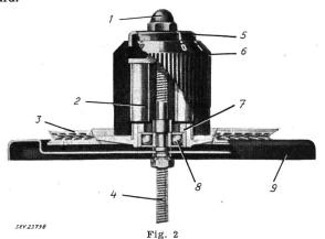
Schnitt durch eine Bremse zur Konstanthaltung der Garnspannung in der Textilindustrie
