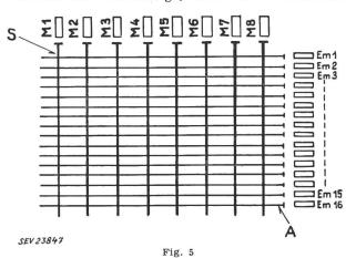
Kreuzwähler-Anordnung für  $8 \times 16 = 128$  Kreuzpunkte S Schaltstangen mit Hubmagneten M; A Aggregate mit Magnetspulen Em
