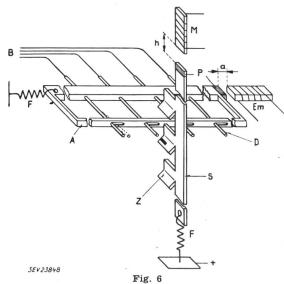
Schematischer Aufbau des Kreuzwählers
