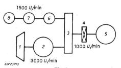
Fig. 1 Prinzipielle Anordnung von Einphasen- und Drehstromgenerator in einem Dampfkraftwerk nach dem Vorschlag von Prof. Marguerre
