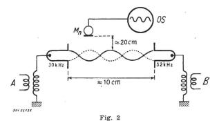
Nachweis des Differenztones A Ultraschallquelle 30 kHz; B Ultraschallquelle 32 kHz;  $M_n$  Mikrophon nur für Tonfrequenzen; OS Oszillogramm des Schwebungstones von 2 kHz
