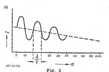
Schallintensität I in Funktion des Abstandes a der beiden Ultraschallwellen voneinander
