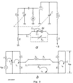
Kristall-Impedanz-Messgerät a Prinzipschema; b Ersatzschaltbild
