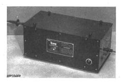
und hochohmigen Widerständen. Gehäuse des Apparates aus Hartpapierplatten. Schalter, Signallampe, Kleinsicherung und Temperaturschalter im Primärstromkreis. Versenkter Apparatestecker 2 P+E, 6 A, 250 V. Dreiadrige Zuleitung mit 2 P+E-Stecker und Apparatesteckdose.
