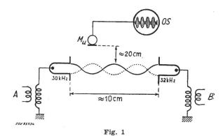
Nachweis zweier Ultraschallfrequenzen mit Schwebung: A Ultraschallquelle 30 kHz; B Ultraschallquelle 32 kHz;  $M_{\rm H}$  ultraschall-empfindliches Mikrophon; OS typischest Überlagerungs-Oszillogramm mit Schwebung von 2 kHz
