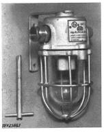
Explosionssicherer Beleuchgemäss tungskörper Abbildung, für 25-W-Glühlampen. Gussgehäuse mit Winkel aus Eisen für Wandmontage. Fassungseinsatz E 14 aus keramischem Material mit Unterbrechungskontakt in Schutzart druckfester Kapselung. Schutzglocke aus Pressglas Schutzkorb aus Stahldraht. Erdungsklemmen innen und aussen am Gehäuse. Leitereinführung durch Stopfbüchse aus Metall.
