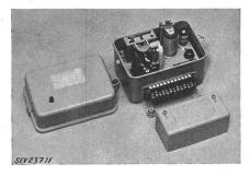
stärkerröhre, ein Umschaltrelais, ein Bimetall-Verriegelungsschalter und Schaltelemente. Druckknopf für Wiedereinschal-
