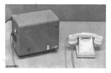
der Tischstation, welches auch zum Abhören verwendet werden kann. Speisung über Transformator mit getrennten Wicklungen. Antrieb der Plasticplatte durch Kurzschlussanker-motor. Zweiröhrenverstärker mit Telephon-Eingangsübertrager. Gehäuse des Verstärkers aus Metall. Festangeschlossene Rundschnüre für Telephon und Netz. Anschluss eines Diktiergerätes möglich.
