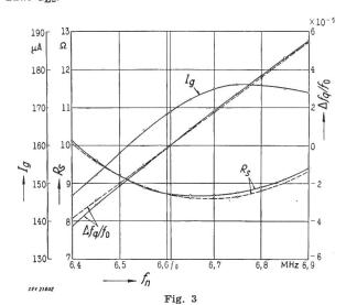
Messfehler in Funktion der Frequenzabweichung Gitterstrom;  $R_{sa}$  Ersatzwiderstand;  $\Delta f_q/f_0$  Frequenzabweichung;  $f_n$  Oszillatorfrequenz bei eingeschaltetem Ersatzwiderstand
