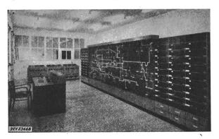
Fig. 2 Vorderansicht der Netzmodellanlage mit Messtisch, Generatorpulten, Knotenpunkttafel und seitlichen Fächerschränken
