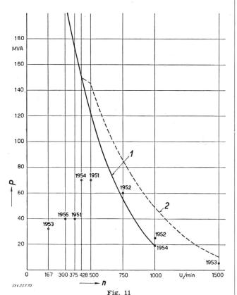
Grenzleistungen P von Drehstromgeneratoren mit ausgeprägten Polen in Funktion der Drehzahl n
