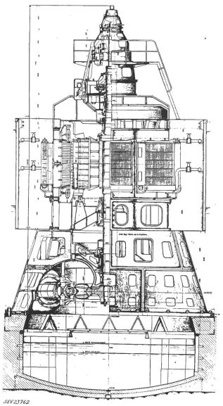
Fig. 2 Generator des Kraftwerkes Innertkirchen 47 500 kVA, 428 U./min, 50 Hz
