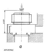
sog. Kettenrotoren, die aus Blechsegmenten erst am Aufstellungsort der Maschinen zusammengesetzt werden, können dagegen in der Fabrik nicht geschleudert werden.
