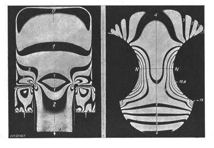
Eine zweite Begrenzung liegt in der Beanspruchung des Kranzes selbst, der seine eigene Fliehkraft und die der Pole aufnehmen muss. Die Kränze werden aus geschmiedeten Stahlringen oder aus Elektrostahlgussringen ausgeführt, die, solange es die Transportverhältnisse gestatten, einteilig sind. Wenn der äussere Kranzdurchmesser 4,2 m übersteigt, werden die Kränze mehrteilig ausgeführt, wobei der Verbindungsstelle besondere Auf-
