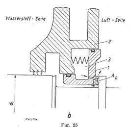
Grundsätzliche Arten der Wellendichtungen bei wasserstoff-gekühlten Turbogeneratoren
