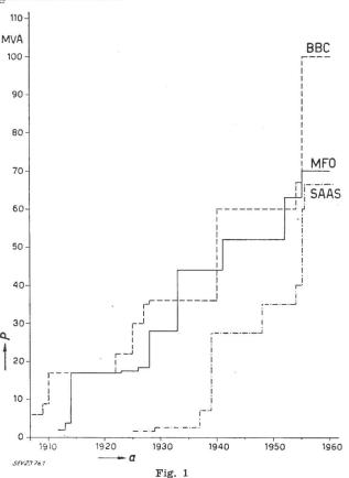
Entwicklung der Einheitsleistungen P von Wasserkraftgeneratoren im Verlauf der Jahre 1910...1960
