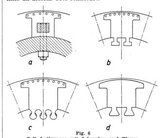
Polbefestigungen mit Schrauben und Klauen a Schrauben; b Rechteckklauen; c Rundklauen (Bauart MFO); d Schwalbenschwanzförmige Klauen (Bauart BBC)
