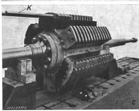
Fig. 15 und 19) — bei grossen Leistungen meistens aus unmagnetischem Stahl — eingelegt, die in Fig. 19 sowie im oberen Teil der Fig. 15 zwischen
