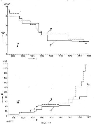
Verlauf des Gewichtes pro kVA  $P_g$  bei Turbogeneratoren Verlauf der jeweils grössten ausgeführten Einheitsleistungen P für die Jahre 1910...1955 a Bestelljahr;  $G_K$  als Kurzschluss-Generator ausgeführt 1 Kurven MFO; 2 Kurven BBC
