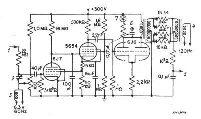
noch die Tatsache, dass diese über beliebig lange Zeit stabile Arbeitsweise durch keine langen Ansprechzeiten (siehe unter 1.) erkauft wird. Der entwickelte Hauptverstärker ist als Ausführungsbeispiel in Fig. 2 dargestellt. Die Verstärkerdaten sind:
