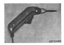
aus wenigen Windungen blanken Flachkupfers. Löteinsatz als Drahtschlaufe ausgebildet und mit Schraubklemmen befestigt. Einpoliger Schalter und Umschalter 115/220 V eingebaut. Zuleitung zweiadrige Gummiaderschnur mit 2 P-Stecker, fest angeschlossen.
