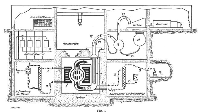
Schema des Breeder-Reaktors mit kontinuierlicher Aufbereitung des flüssigen metallenen Brennstoffes nach einem Vorschlag des Brookhaven National Laboratory
