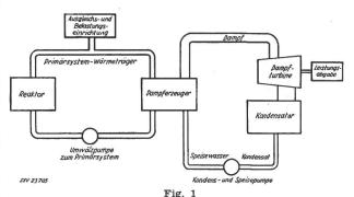
Prinzipschema des Kernenergie-Antriebes
