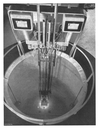
(thermischen) Neutronen werden die Kapseln ausserhalb des Kernes angebracht, für die Bestrahlung mit schnellen Neutronen dagegen innerhalb des Kernes.
