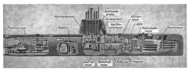
Fig. 2 Schematische Skizze des «USS Nautilus»
