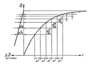
Fig. 1 Methode zur Bestimmung der Enderwärmung bei Transformatoren für Dauerbetrieb
