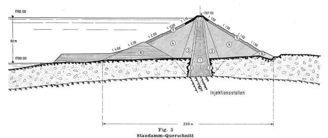
1 Dichtungskern; 2 Filterschicht; 3 Alluvionmaterial; 4 Bergschuttmaterial, Blöcke maximal 0,25 m³; 5 Bergschuttmaterial, Blöcke maximal 0,75 m³ (gepackt); 6 Bergschutt- und Stollenausbruchmaterial, Blöcke maximal 0,75 m³
