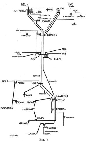
Prinzipschema des Hochspannungsnetzes der Atel Die Verbindungen mit den angrenzenden Netzen des In- und Auslandes sind angedeutet. Die dicken Linien stellen 150-kV-Leitungen (mit Ausnahme der 225-kV-Leitung Lavorgo—Lukmanier—Mettlen), die dünnen Linien 50-kV-Leitungen dar.
