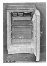
Kühlschrank gemäss Abbildung. Kompressor-Kühlaggregat mit natürlicher Luftkühlung. Kolbenkompressor und Einphasen-Kurzschlussankermotor mit Hilfswicklung zu einem Block vereinigt. Relais zum Ausschalten der Hilfswicklung nach erfolgtem An-lauf. Separater Motorschutzschalter. Raum für Eisschubladen und Gefrierkonserven auf dem flachen Verdampfer. Ver-Temperaturregler stellbarer mit Ausschaltstellung. häuse aus weiss lackiertem Kühlraumwandungen Blech. emailliert. Dreiadrige Zulei-
