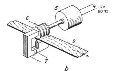
Fig. 1 a Aufnahmekopf; b Abtastkopf 1 Gleichstromspeisung; 2 Magnetband; 3 verzahnter Eisenstab; 4 zum Starkstromnetz; 5 Synchronmotor; 6 Abtastschraube; 7 Ausgangsspannung
