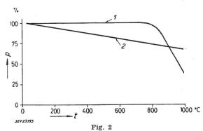
Druck- und Zugfestigkeit p in Abhängigkeit von der Temperatur t für Typ 221 1 Druck; 2 Zug
