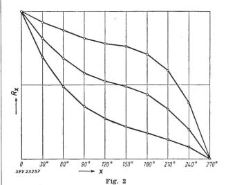
Beispiele von Widerstandscharakteristiken Einige Charakteristiken, die mit Parallelwiderständen an einem Potentiometer von insgesamt 270 °-Bogenlänge erreicht werden können  $R_x$  angezapfter Widerstand; x Stellung des Schleifkontaktes
