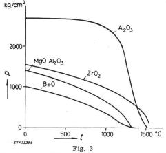
Zugfestigkeit p in Abhängigkeit von der Temperatur t für oxydkeramische Isolierstoffe
