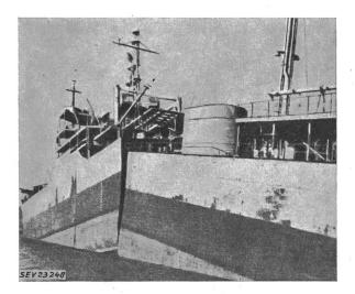
Fig. 1 Sprödbruch eines geschweissten Tankschiffes (nach Welding Journal, 1953, Heft 10)
