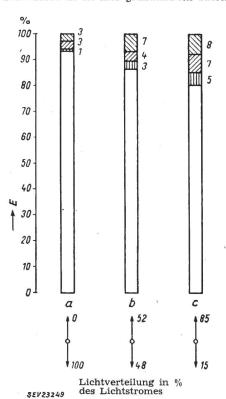
Fig. 1 Verschmutzungsverluste verschiedener Leuchtentypen, gemessen in Büroräumen nach 2 Jahren Benützungsdauer (nach Oetting und Tuttle)
