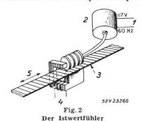
1 zum Starkstromnetz; 2 Synchronmotor; 3 genau registrierte transversale Magnetisierungslinien; 4 Ausgangsspannung; 5 Stahlmaßstab
