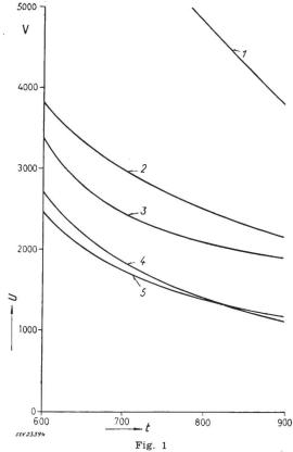
Durchschlagspannung U (Gleichstrom) in Abhängigkeit von der Temperatur t für einige silikatkeramische Isolierstoffe bei 1,5 mm Isolierstoffdicke
