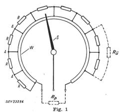
Potentiometer mit Anzapfungen und Parallelwiderständen A Anzapfungen; R Parallelwiderstände; R, Nebenschluss-widerstand; Rii Überbrückungswiderstand; W Widerstands-wicklung; 5 Schleifkontakt
