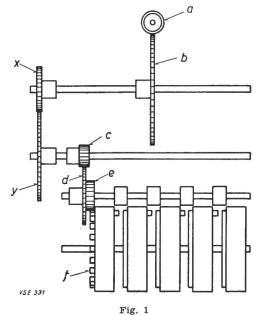
Schematischer Aufbau eines Zählerwerkes
