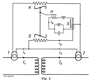
Schema des einpoligen, stromabhängigen, einschaltsichern Differentialschutzes
