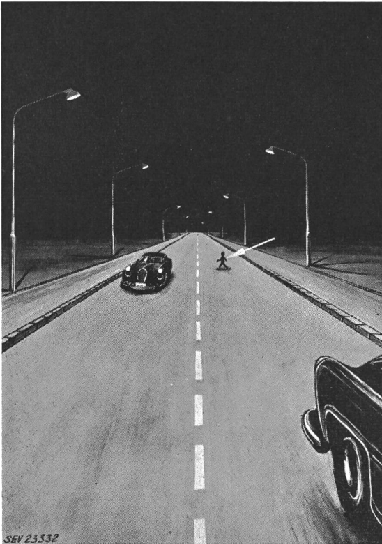
Fig. 7 Fahrzeuge verkehren mit Positionslichtern; zweiseitige Leuchtenanordnung Hindernis durch Pfeil verdeutlicht
