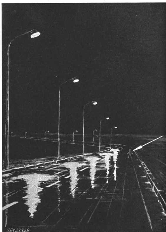
Fig. 4 Reflexstreifen nur links der Fahrspur des Beobachters; einseitige Leuchtenanordnung; sehr nasse Strasse Hindernis durch Pfeil verdeutlicht
