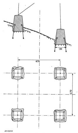
Fig. 10 Felsfundation mit Rundeisenankern für einen Abspannmast einer 225-kV-Leitung
