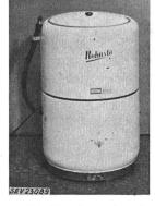
Waschmaschine gemäss Abbildung, ohne Heizung, mit emailliertem Wäschebehälter. Die Waschvorrichtung, bestehend aus einer rotierenden, mit Rippen versehenen Scheibe, ist am Boden des Wäschebehälters exzentrisch angeordnet. Sie setzt das Waschwasser und damit die Wäsche in Bewegung. Antrieb durch ventilierten Einphasen-Kurzschlussankermotor mit Hilfswicklung, Kondensator und Zentrifugalschalter. Schalter eingebaut. Dreiadrige Zuleitung, fest angeschlossen.
