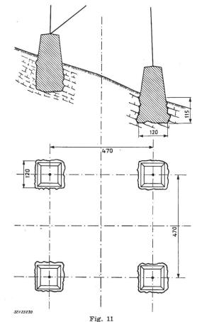
Felsfundation ohne Rundeisenanker für einen Abspannmast für eine 225-kV-Leitung  $M_K = 418.7 \text{ tm}; \ 1.5 \ Z = 74.4 \ \text{t}; \ V_B = 14.2 \ \text{m}^3$
