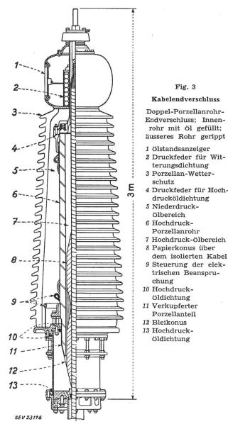
Abschirmung: 2 Lagen von gelochtem metallisiertem Papier Armierung: Stahlband der Dimensionen 2,6 × 5,2 mm Bleimanteldicke: 2 mm
