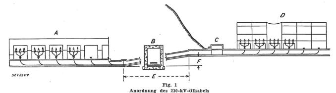
A 230-kV-Endverschlüsse in der Zentrale (vorläufig 4, später 6 Kreise); B vergrösserter Querschnitt durch den Tunnel; C Relais-Raum; D 230-kV-Endverschlüsse in der Freiluft-Schaltanlage; E Tunnellänge ca. 400 m; F Niveaudifferenz ca. 46 m
