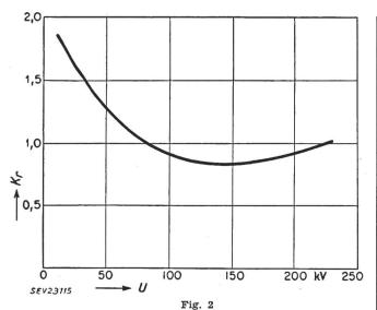
Relative Kosten der Kabel und Tunnel für die Übertragung von 260 MW
