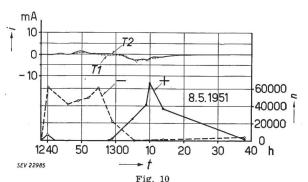
Verlauf der Ionendichte und des gleichzeitigen Glimmstromes an Turm T1 und T2
