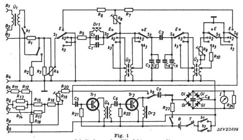
Schaltschema des Klirrfaktormessgerätes T Einschaltknopf; b1, b2 Schaltbuchsen zur Schonung der Batterie
