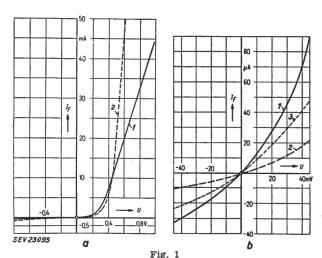
Vergleich der statischen Kennlinien von AlSb-, Ge- und Si-Dioden
