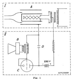
Prinzipschema eines Anzeigegerätes für Undichtigkeitsstellen I Fühler; II Gerät; A empfindliche Zelle; B Lautsprecher; C Glimmlampe; D Ladekondensator
