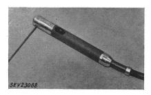
den Teilen isoliert. Schaft aus Hartpapier. Klemmtaste aus Isolierpreßstoff.
