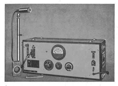
für verschiedene Frequenzen auch vom Schalldruckpegel abhängig ist, wird gleichzeitig mit dem Umschalten auf die verschiedenen Lautstärke-Bereiche ein passendes Netzwerk eingeschaltet, das diesem Verhalten des Ohres Rechnung trägt. Dieses Netzwerk wird bei Schalldruckmessungen abgeschaltet.
