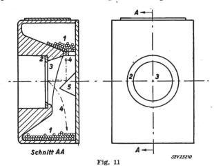
Die Eichtonquelle des Technicum Neuchâtelois 1 Stahlkugel; 2 Ring; 3 Glimmermembran; 4 Bahn einer fallenden Kugel; 5 Prisma
