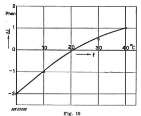
Temperaturabhängigkeit der Anzeige eines Phonmeters mit Kristallmikrophon
