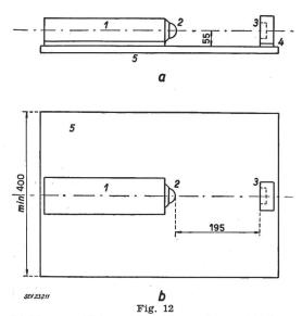
Aufstellung zur Eichung eines Phonmeters mit Entzerrung
