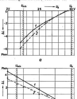
Fig. 9 Abhängigkeit der Anzeige eines tragbaren Phonmeters von den Batteriespannungen
