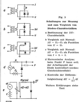
Für feinere Sortierungen empfiehlt sich der Vergleich mit einem Normal. Dazu eignet sich z. B. ein schon geprüftes Element, falls es genügend beständig ist, oder evtl. für grosse Kontrollarbeiten zwei gekoppelte Generatoren, von denen der eine den Strom für das zu prüfende Element abgibt, der andere synchron die vom Element erwartete Spannung U(I) liefert [6].
