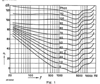
Ohrempfindlichkeitskurven Kurven gleicher Lautstärke p Schalldruck in dB über Nullpegel  $2\cdot 10^{-4}~\mu b;~L$  Lautstärke; f Frequenz
