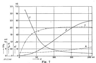
Einfluss der Trägerspannung auf die Eigenschaften des Modulators
