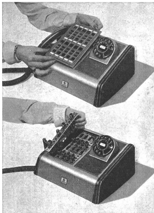
Fig. 2 Öffnen der Telephonstation mit Zugänglichkeit zu allen Teilen
