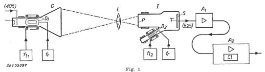
Zeilenumsetzer mit optischem Zwischenbild
