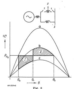
Leistung-Polradwinkelkurven für ein Netz bei verschiedenen Zuständen während einer Störung
