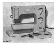
kupplung isoliert eingebaut. Drehzahlregulierung Fussanlasser mit Kohlewiderstand. Glühlämpchen 15 W im Maschinenkopf. Einpoliger Kipphebelschalter eingebaut. Zuleitung dreiadrige Flachschnur mit 2 P-+ E-Stecker und Apparatesteckdose 6 A, 250 V, 2 P + E.
