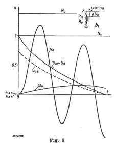
Berechnete Spannungen  $u_A$  und  $u_0$  gegen Erde der Wicklungspunkte A, und  $R_{10}$  bei einem Stoss  $U_S$  auf die oberste Regulierstellung
