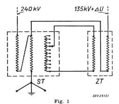
Spar- und Zusatztransformator mit Regulierung der Unterspannung
