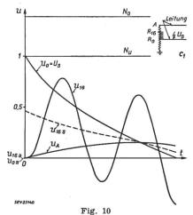
Berechnete Spannungen  $u_{16}$  und  $u_{16}$  gegen Erde der Wicklungspunkte A und  $u_{16}$  bei einem Stoss  $U_S$  auf unterste Regulierstellung
