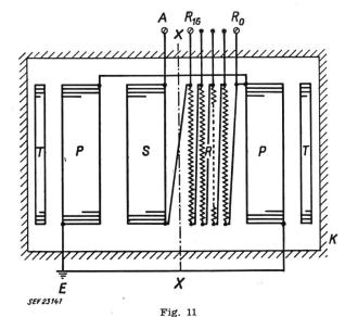
Eisenfenster des Regulierspartransformators mit Regulierwicklung in Lagenanordnung mit 16 Stufen R<sub>0</sub>...R<sub>16</sub>
