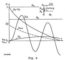
Berechnete Spannungen  $u_{16}$  und  $u_0$  gegen Erde an den Wicklungspunkten  $R_{16}$  und  $R_0$  bei einem Stoss auf die Oberspannungsleitung
