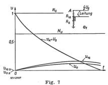
Berechnete Spannungen  $u_{16}$  und  $u_0$  der Wicklungspunkte  $R_{16}$  und  $R_0$  gegen Erde bei einem Stoss  $U_S$  auf die Oberspannungsleitung
