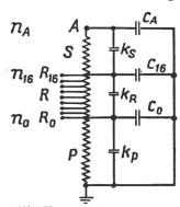
Fig. 3 Ersatzschema des offenen Regulierspartransformators
