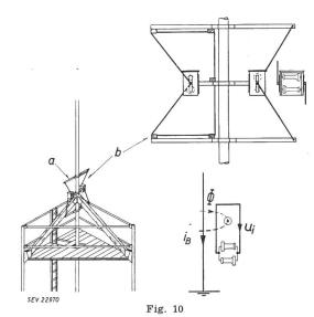
Stromsteilheits-Messeinrichtung auf Turm 2 a nichtisolierte Schleife; b isolierte Schleife;  $i_B$  Blitzstrom;  $u_i$  induzierte Spannung;  $\phi$  Induktionsfluss
