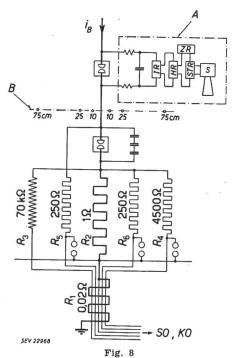
Schema der beiden Blitzstrom-Shunts
