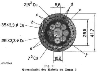
a Messleiter des Schleifen-Oszillographen; b Messleiter des Kathodenstrahl-Oszillographen; c Auslöseleiter; d Polyäthylen-Isolation; e Kupfer-Umklöppelung; f Kupfermantel
