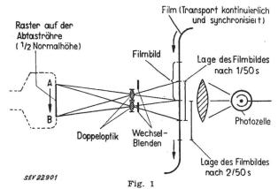
Filmübertragung durch Punktlichtabtastung bei kontinuierlich laufendem Film für Fernsehsysteme mit 50 Hz Vertikalfrequenz, wobei der Filmvorschub teilweise zur Erzeugung der Vertikalabtastung mithilft
