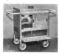
Glimmerisolation und Blechmantel in der Mitte des Wagens senkrecht eingebaut. Einstellbarer Temperaturregler und Signallampe vorhanden. Doppelwandiges Gehäuse aus Leichtmetall mit Wärmeisolation. Handgriffe isoliert. Zuleitung dreiadrige Gummiaderschnur, an einer Verbindungsdose angeschlossen.
