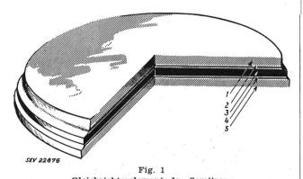
Gleichrichterelement des Semitrons
