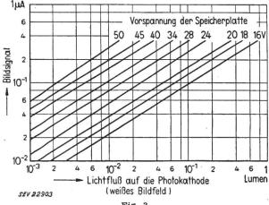
Fig. 3 Übertragungskennlinien des Vidicons Typ 6326 (RCA)
