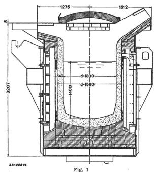
12-t-Induktionsofen der ASEA, Längsschnitt Masse in mm
