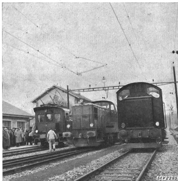
Fig. 3 Drei vom Fahrdraht unabhängige Triebfahrzeuge Links: Kombierter Traktor Tem 21 für wahlweisen Betrieb ab Fahrdraht oder mit Dieselmotor auf Geleisen ohne Fahrdraht; Mitte: Diselelektrische Lokomotive Bm 6/6 Nr. 1501 für schweren Rangierdienst und «Dépannage»; rechts: Dieselhydraulische Werklokomotive der Gebr. Sulzer A.-G., Winterthur (Fabrikat Sulzer/Krupp), 260 kW (350 PS), von den SBB für Versuchsfahrten gemietet
