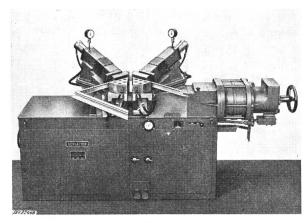
Fig. 13 Vollautomatische Abbrenn-Stumpfschweissmaschine für Gehrungsschweissung
