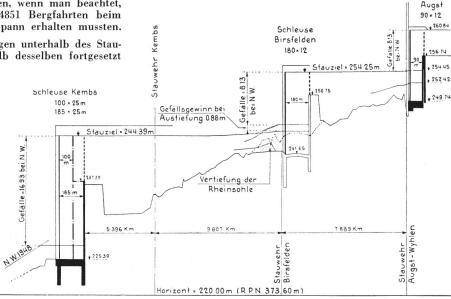
Fig. 5 Gefällstufen Birsfelden und Kembs Längenprofil
