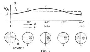
Wirkungsweise des photoelektrischen Abtasters  $\Phi$  Lichtstrom; A Lage der Scheibe; t Zeit a Lichtstrom, wenn der Schwerpunkt der Abbildung mit dem Scheibenzentrum zusammenfällt; b Abbildung des Sterns
