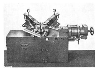
Fig. 13 Vollautomatische Abbrenn-Stumpfschweissmaschine für Gehrungsschweissung
