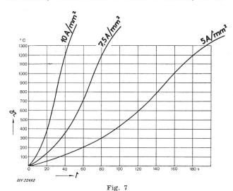
${\bf Abbrenn\text{-}Stumpfschweissung}$  Spezifische Stromdichte in Funktion der Temperatur  ${\it S}$  bzw der Vorwärmzeit t bei Flußstahl
