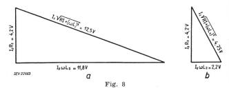
Diagramm der Sekundärspannungen von Abbrenn-Stumpfschweissmaschinen
