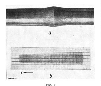
${\bf Preßstumpfschweissung} \\ a \ {\it geschweisstes} \ {\it Werkstück;} \ b \ {\it Oszillogramm} \ {\it der} \ {\it Stromaufnahme} \\ nahme$
