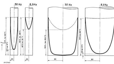
Fig. 10 Stromverdrängung in Flußstahl bei Abbrenn-Stumpfschweissung Masse in mm
