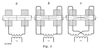
Elektrodenanordnungen von Stumpfschweissmaschinen a Stromübertritt einseitig nur durch untere Elektroden; b Stromübertritt doppelseitig durch untere und obere Elektroden; c Stromübertritt doppelseitig mit sich kreuzenden Strombahnen durch obere und untere Elektroden
