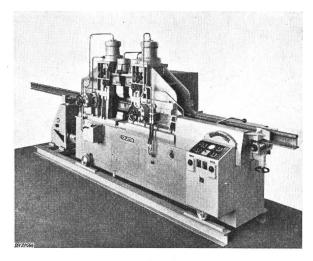
Fig. 11 Vollautomatische Stumpfschweissmaschine für Eisenbahnschienen
