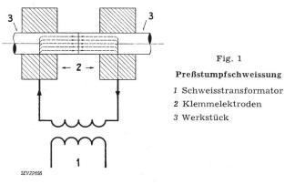
Stückenden zu einer soliden Verbindung, wobei die auf Weissglut erhitzten Materialpartien zu einer wulstförmigen Verdickung aufgestaucht werden.
