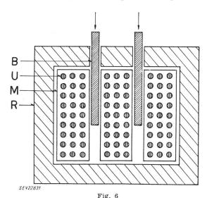
Schema eines Uran-Graphit-Reaktors
