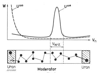
Einfangquerschnitte von U<sup>235</sup> und U<sup>238</sup> für verschiedene Neutronengeschwindigkeiten und Verlangsamung der Neutronen im Moderator
