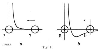
Kraft zwischen zwei Elementarteilchen in Abhängigkeit ihres gegenseitigen Abstandes a Neutron — Neutron b Proton — Proton
