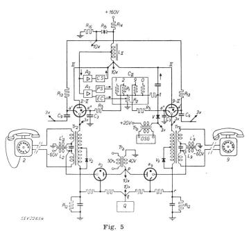
Schema der Signalgebung und der Sprechverbindungen zwischen zwei Teilnehmern (2 und 9) über eine elektronische Fernsprechzentrale
