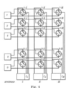
Prinzipschema einer elektronischen Fernsprechzentrale für zehn Anschlüsse
