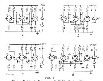
Einige Relaisschaltungen mit Kaltkathodenröhren Ob die Röhre I gezündet ist oder nicht, hängt vom Zustand der Röhren A und B (und evtl. C) ab, und zwar in gleicher Weise wie die Erregung des nebenstehend gezeichneten Relais I von der Stellung der Kontakte  $\alpha$  und  $\beta$  (sowie evtl.  $\gamma$ ) abhängig ist. Der Widerstandwert von R und R' ist sehr gross gegenüber dem Durchlasswiderstand der Gleichrichterelemente
