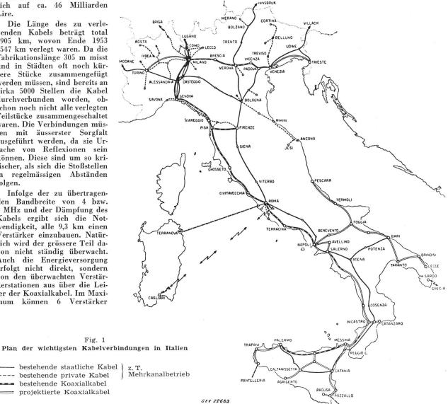
auf jeder Seite von einer überwachten Station bedient werden, so dass die überwachten Stationen bis zu 120 km auseinander liegen können. Im geplanten Netz ist die grösste Distanz 111 km.
