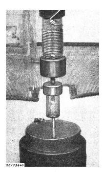
Fig. 1 Stabförmige feste Elektrode, gegenüber schwingender Oberfläche eines Ultraschallgebers angeordnet oben: Oszillatorspule
