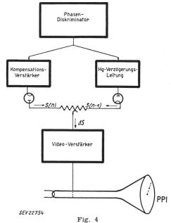
Blockschema der Apparaturen für die Unterdrückung der kohärenten Signale» von Standzeichen mit Hilfe einer Verzögerungsleitung
