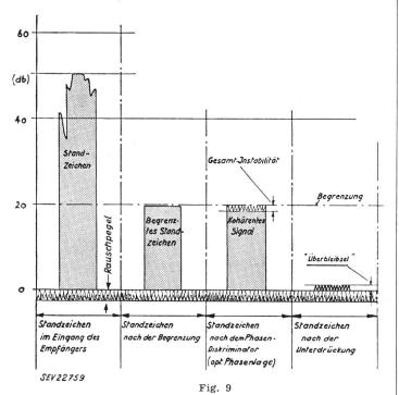
Impuls-Diagramm eines Standzeichens beim Durchlaufen des begrenzenden ZF-Verstärkers, des Phasen-Diskriminators und der Subtraktions-Schaltung (Unterdrückung)
