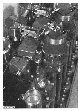
Fig. 6 «Sprechköpfe» der Verzögerungsleitungen
