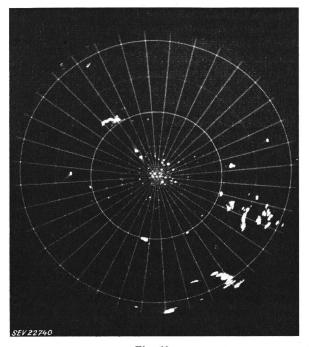
Fig. 10 Ausschnitt aus Fig. 9 mit Standzeichen-Unterdrückung
