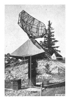
Fig. 20 Flab-Such- und Zielzuweisungs-Radargerät Reichweite ca. 100 km (USA/Italien)
