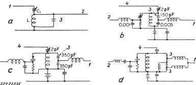
Als nächstes wurde der zweistufige Verstärker von Fig. 2a aufgebaut. Die grösste Verstärkung wurde bei ca. 60 V Vorspannung und effektiv 40 V Trägerfrequenz erzielt. Darauf wurde eine Ausgangsstufe konstruiert, welche einen Lautspre-
