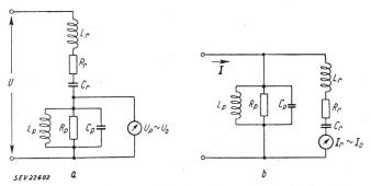
Fig. 1 Messchaltung mit einem Serie- und einem Parallelresonanzkreis
