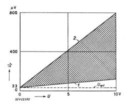
Fig. 1 Störspannungen von 0,5-W-Widerständen, 1  $M\Omega,$  in Abhängigkeit von der angelegten Gleichspannung
