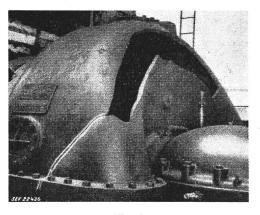
Fig. 1 Infolge unsachgemässer Reinigung explodierte Dampfturbine
