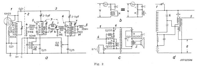
Beispiele von dielektrischen Spannungs- und Leistungsverstärkern
