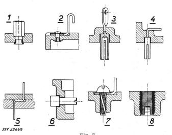
Fig. 7 Nachträgliche Befestigung von Metallteilen an Kunststoff-Formstücken
