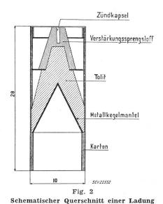
Die Ladung ist so angeordnet, dass die Sprengwirkung genau in Richtung des Objektes zielt (Fig. 2). Es werden folgende Ladungen hergestellt: hatte, die brauchbare Resultate ergaben, schien es angezeigt, auch in der Schweiz entsprechende Versuche durchzuführen.
