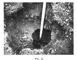
Versuch Nr. 7 Sprengung in Kies. Oberste 65 cm wurden vorgängig mit der Schaufel ausgehoben. Verfestigte Schicht in 80 cm Tiefe
