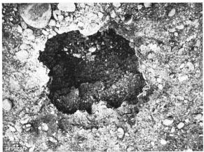
Fig. 9 Versuch Nr. 6 Sprengung von Kies. Man erkennt knapp unter der Oberfläche die verfestigte Schicht
