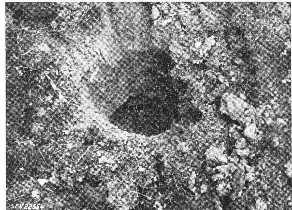
Fig. 4 Versuch Nr. 1 Ausgesprengtes Loch, oben Humus, unten Sandboden. Der Boden wurde durch die Sprengung komprimiert.
