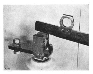
Moderner Trennmesserkontakt Versilberte Kontaktfläche, Unterteilung in Lamellen, Schraubenfedern zur Erzeugung des Kontaktdruckes.
