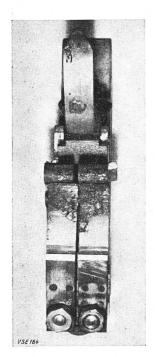
Fig. 12 Beispiel einer Zerstörung der Schalterkontakte bei einem Apparat, der nur selten in Funktion tritt.
