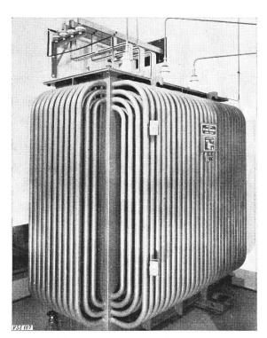
Fig. 15 Transformator mit natürlicher Kühlung
