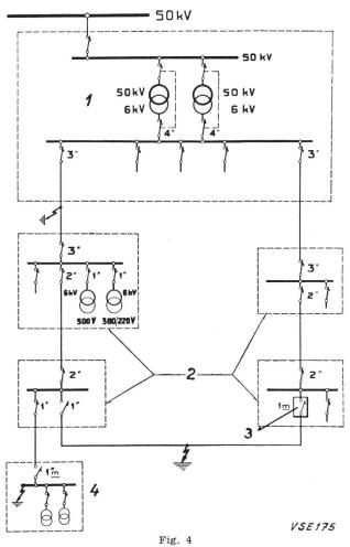
Beispiel einer Staffelung der Ausschaltzeiten bei Verwendung von Hauptstromrelais (6 kV-Netz)
