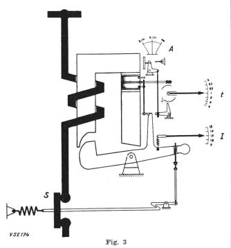
Prinzipschema eines Hauptstromrelais
