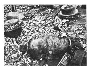
Fig. 9 Die Wicklung eines 125 kV-Oelspannungswandlers nach dem Unfall der Fig. 8
