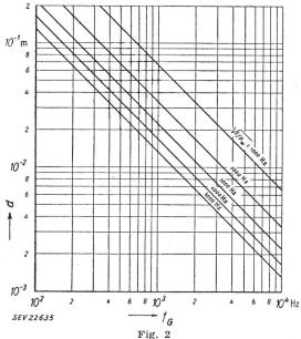
Kritische Frequenz (Grenzfrequenz)  $f_G$  in Abhängigkeit von der Wandstärke d und longitudinaler Schallgeschwindigkeit
