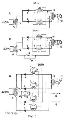
Entwicklung der Schaltung des magnetischen Verstärkers 1, 2, 3, 4 Steuerdrosselspulen; 5, 6, 7, 8 Gleichrichter; 9 Eingangstransformator; 10 Ausgangstransformator; 11 Siebkondensator; 12 Synchronmotor; 13 Gleichstromwiderstand; 14 Überbrückungskondensator; 15 Steuerfeld; 16 Hauptfeld; 400 Hz: Speisespannung; 60 Hz: Steuerspannung
