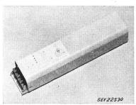
Kupferdraht. Eisenblechgehäuse von 170 mm Länge. Stirnseiten offen. Anschlussklemmen mit Sockel aus Isolierpreßstoff und Unterlage aus Presspan. Gerät nur für Einbau in geschlossene Blecharmaturen.
