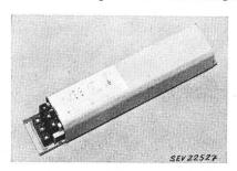
170 mm Länge. Stirnseiten offen. Anschlussklemmen mit Sockel aus Isolierpreßstoff und Unterlage aus Presspan. Gerät nur für Einbau in geschlossene Blecharmaturen.
