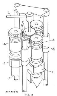
Ausführungsskizze eines Drehstrom-Rollstromrichters in Aussenrollenbauweise
