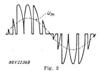
Ungesiebte Spannung an der Sekundärwicklung des Ausgangstransformators
