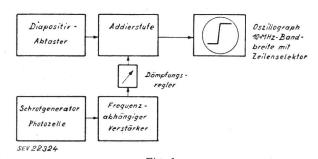
Fig. 1 Anordnung zur Messung des Störeinflusses von Schrot auf die Bildqualität
