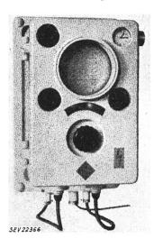
sere Ortungsmöglichkeiten. Demgegenüber ist aber die Reichweite begrenzt, weil die Schallabsorption im Wasser mit der Frequenz zunimmt. Als Kompromiss zwischen erwünschter Bündelung und Reichweite hat sich die Frequenz von 30 kHz durchgesetzt. Die Zahl der Schallimpulse in der Zeiteinheit richtet sich nach der gewünschten Lottiefe, also nach dem Messbereich (z. B. 78/min).
