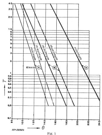
«Thermische» Lebensdauer von elektrischen Maschinen T Lebensdauer in Jahren;  $\Theta$  mittlere Wicklungstemperatur in °C
