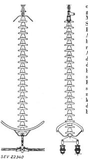
Neben der Beanspruchung durch Stoßspannungen sind in vermehrtem Masse die betriebsmässigen Schaltüberspannungen von Bedeutung. Isolatoren und Armaturen können bei höheren Spannungen zu Korona- und Radiostörungen Anlass geben. Durch besondere Schutzringe kann aber die Feldstärke oft soweit herabgesetzt werden, dass sie unterhalb des Glimm-Einsatzpunktes bleibt. Es scheint, dass Schutzmassnahmen erst oberhalb 300 kV notwendig sind. Besondere Konstruktionen sind bei Bündelleitern zu ent-
