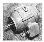
Offener, ventilierter Drehstrom-Kurzschlussankermotor gemäss Abbildung. Leichtmetallgehäuse. Kupferwicklung. Anschlussklemmen in verschraubtem, mit Stahlpanzerrohrgewinde versehenen Klemmenkasten.
