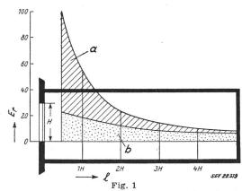
Anteil der direkten und indirekten Beleuchtung in einem Raum mit einseitig angeordnetem Fenster und unbehinderter Aussicht
