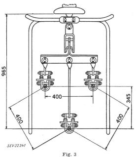
Schutzring und Leiteranordnung einer russischen 400/420-kV-Dreibündelleitung (Masse in mm)
