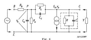
II-Ersatzbild des Junction-Transistors  $G_m v_e$  Einströmung;  $v_e$  Spannung zwischen P und EWeitere Bezeichnungen siehe in Fig. 5
