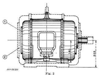
Grössenvergleich zweier Motoren gleicher Leistung in den Isolationsklassen H (1) und A (2)
