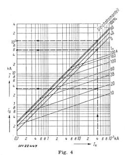
Abschaltung von Wechselstrom-Kurzschlüssen durch träge Schmelzeinsätze
