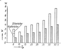
Fig. 7 Eigenverbrauch von Schmelzeinsätzen W Eigenverbrauch; Tp Typ nach Nennstromstärke
