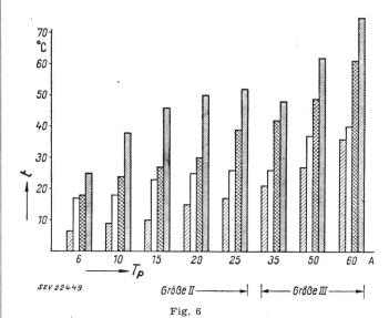
Erwärmung von Schraubkappen bei Belastung des Schmelzeinsatzes mit Nennstrom bzw. kleinem Prüfstrom
