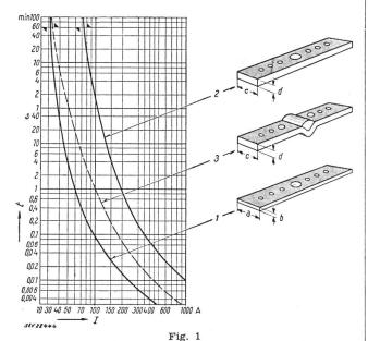
Stromzeitkennlinien von Schmelzeinsätzen mit verschiedenartig geformten Schmelzleitern 1, 2 «flink»; 3 «träge»; t Zeit; I Strom
