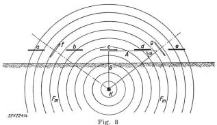
Genaue örtliche Feststellung eines unterirdisch verlegten Kabels
