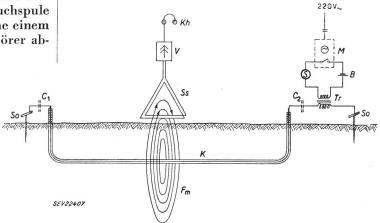
unterschieden werden können, wird der Signalstrom mit einem Taktgeber in einem bestimmten Rhythmus unterbrochen (Morsezeichen). Der Taktgeber wird durch einen kleinen Synchronmotor, oder, wenn man vom Netz unabhängig sein will, durch ein Uhrwerk angetrieben.
