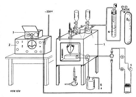
Fig. 2 Versuchsapparatur für Untersuchun-gen über das Herzkammerflimmern
