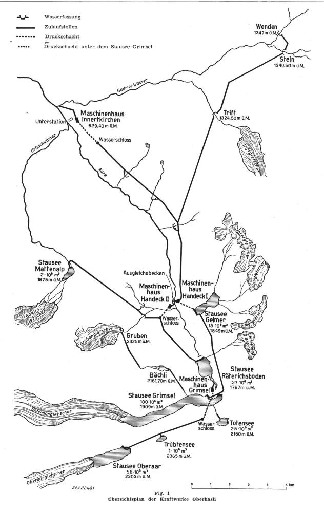
Einzugsgebiet der Oberaar und 1,8 km² auf dasjenige des Trübtensees entfallen. Der totale Jahresabfluss beträgt 40...44·106 m³, entsprechend einem spezifischen Abflusswert von 1,9...2,08·106 m³/km². Der Nutzinhalt des Oberaarsees wurde auf Grund eingehender Untersuchungen auf 58·106 m³ festgelegt, so dass sich bei einem minimalen Zufluss von 38·106 m³ eine nach dem Oberaarsee zu pumpende Fördermenge von 20·106 m³ ergibt.
